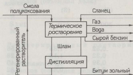
Рис. 1 Схема термического растворения сернистых сланцев при получении органических вяжущих для дорожного строительства и бензина
