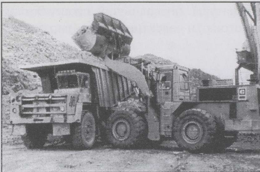
Фото 4. Погрузка горной массы в автосамосвал «БелАЗ» с помощью погрузчика Cat988В (фото В. Пийра)
